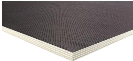
Siebdruckplatte WISA Wire ist eine mit dunkelbraunem Phenolharzfilm beschichtete Sperrholzplatte mit einer rutschfesten Siebprägung. Das Produkt wird als Bodenmaterial in der Transportindustrie verwendet, z. B. für Anhänger, Pferdetransporter und Eisenbahnwaggons, jedoch auch für Bauprojekte wie Lagerhallen, Verladerampen und Gerüste. Wire ist ein universell einsetzbares Material für technische Fußbodenanwendungen.
