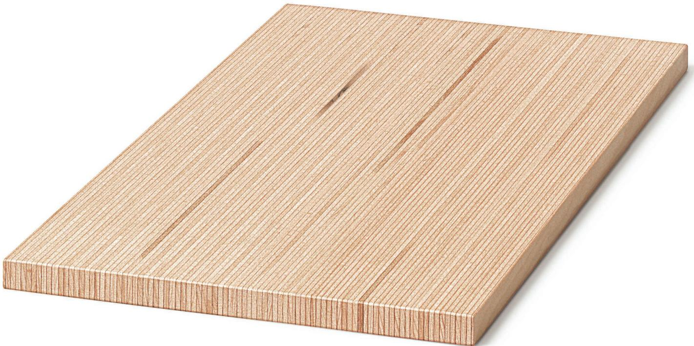
Platte aus phenolharzverleimtem Buchen-Furnierschichtholz mit stehenden Furnieren, Flächen in Linienoptik mit dunklen Fugen, Flächen geschliffen mit Körnung 80, Kanten scharfkantig.
